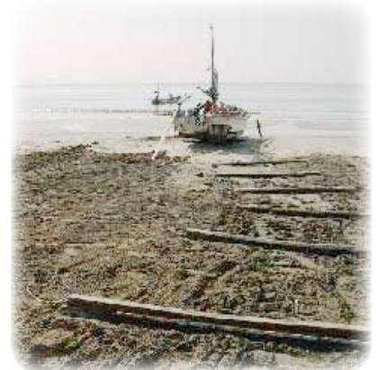
材木座や由比ガ浜では、まくら木状の「しゅら棒」を砂浜に並べ、上を滑らせて船を海に入れます
